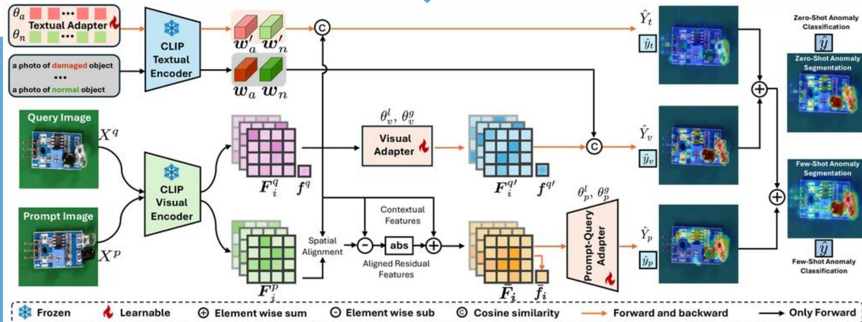
Adaptclip: 由三个可插的适配器组成，即视觉适配器，文本适配器和及时引用适配器。首先，前两个适配器交替学习用于零样本异常检测的视觉和文本表示。提示查询适配器进一步学习查询图像与其对应的正常提示之间的比较能力，用于少样本异常检测。一旦训练完成，它只需少量样本甚至零样本的正常图像提示即可分割任何异常。
